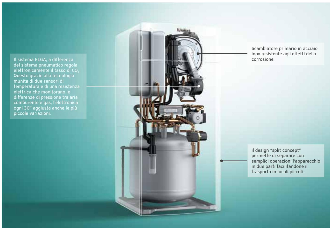
Il sistema ELGA, a differenza del sistema pneumatico regola elettronicamente il tasso di CO<sub>2</sub>. Questo grazie alla tecnologia munita di due sensori di temperatura e di una resistenza elettrica che monitorano le differenze di pressione tra aria comburente e gas, l'elettronica ogni 30" aggiusta anche le più piccole variazioni.
