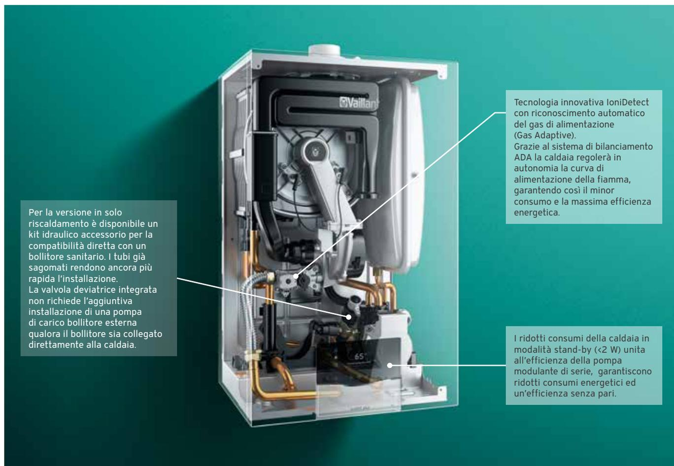
Per la versione in solo riscaldamento è disponibile un kit idraulico accessorio per la compatibilità diretta con un bollitore sanitario. I tubi già sagomati rendono ancora più rapida l'installazione. La valvola deviatrice integrata non richiede l'aggiuntiva installazione di una pompa di carico bollitore esterna qualora il bollitore sia collegato direttamente alla caldaia.
