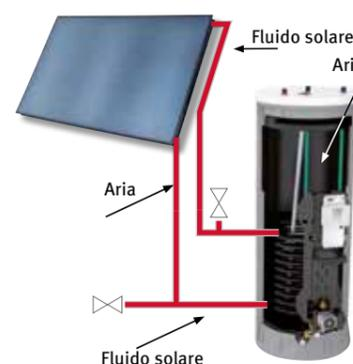
Sistema in funzionamento con presenza d'irraggiamento
