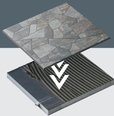
Pavimento posato direttamente sul pannello
